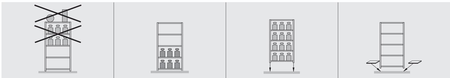
**D** Deckböden ohne seitliche Absturzsicherung sind ungeeignet zur Lagergutablage. Bei unterschiedlichen Fachlasten sollten die höheren Lasten im unteren Bereich des Regals konzentriert werden. Der Betreiber muss gewährleisten, dass der Fußboden die Lasten aus dem Stützrahmen sicher aufnehmen kann. Die Fußbodenbeschaffenheit muss den Forderungen der DIN 18202 Pkt. 4, Tab. 3, Zeile 3 entsprechen. Ist der Fußboden magnesitgebunden, müssen Kunststoffplatten unterlegt werden.
